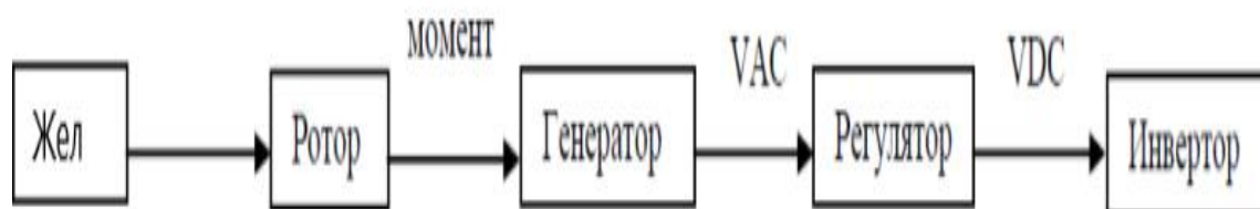
1.4 Сурет– Автономды және желілік тұтынушының энергия тұтыну сұлбасы
