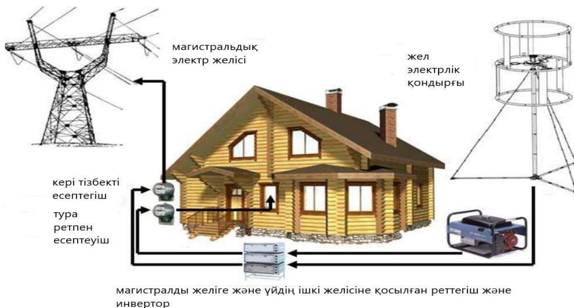
1.4 Сурет– Автономды және желілік тұтынушының энергия тұтыну сұлбасы
